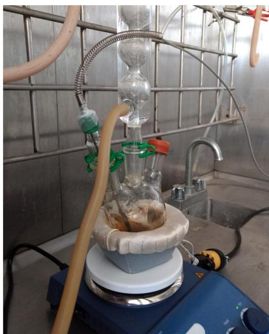
**Fig. 16** De izq. a derecha, boca 1: adaptador con termopar, boca central: condensador de rosario, boca 3: septa para inyección de OLA+S.
