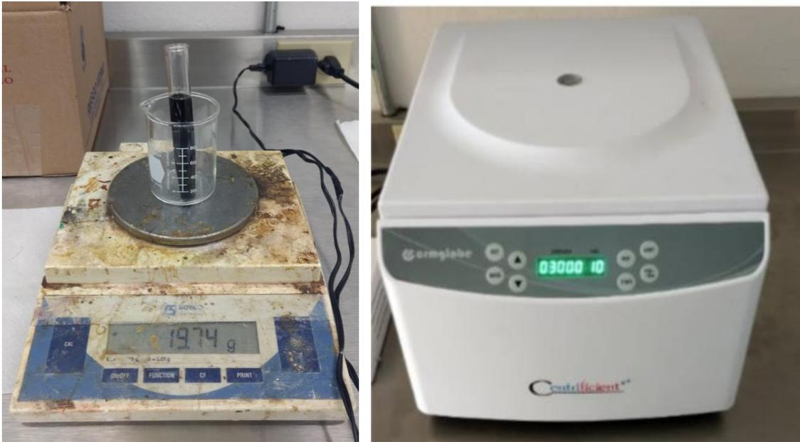
**Fig. 21 (izq.)** Tubos de vidrio con mezcla de nanopartículas. **(der.)** Centrifuga a 3000 RPM y 10 min.
