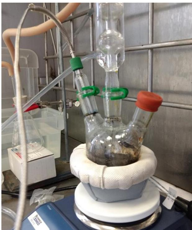
**Fig. 19** Mezcla de precursores a 270°C después de la inyección de OLA+S.
