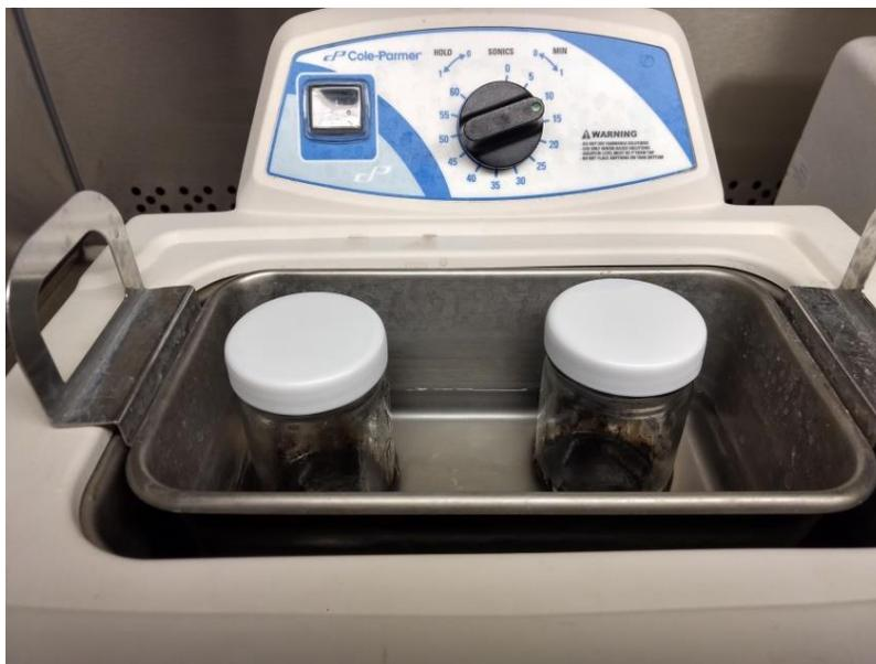
**Fig. 25** Preparación de la tinta solar en el equipo de ultrasonido.
