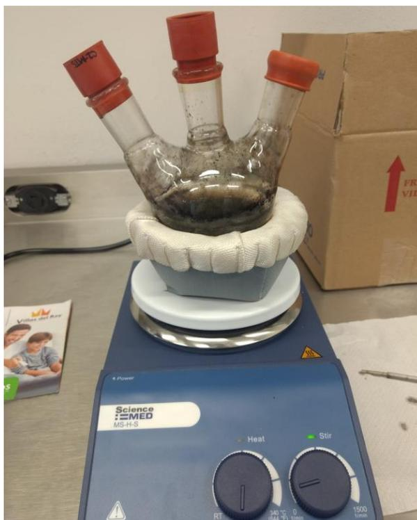
**Fig. 20** Nanopartículas en agitación con etanol : tolueno en relación 5 : 1.
