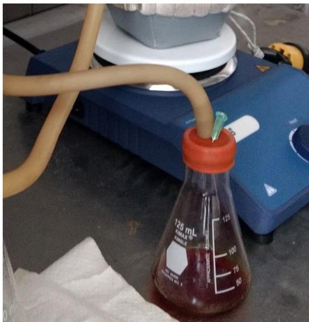
**Fig. 18** Mezcla de OLA con S en flujo de nitrógeno.
