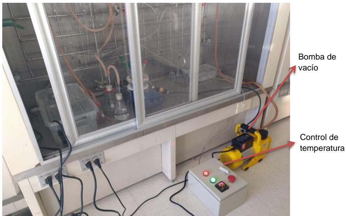
**Fig. 15** Disposición del equipo para síntesis b.
