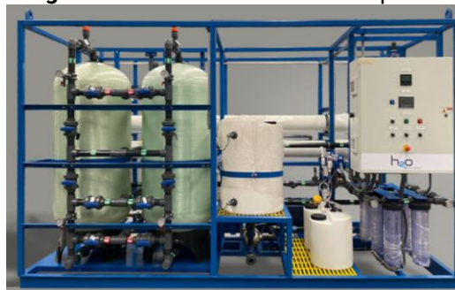
Figura 58. Planta desaladora compacta.
