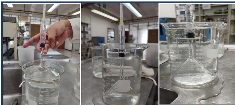
Figura 1: Imágenes del montaje del sistema para la recolección del gas producido por el comprimido efervescente.
