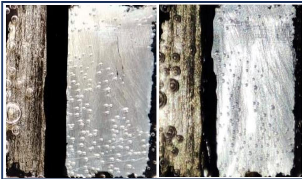
Figura 25: Liberación de hidrógeno generado con una disolución de magnesio del par galvánico SS-magnesio y par galvánico zinc-magnesio.
