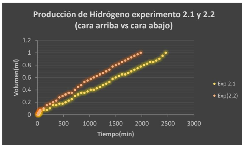
Figura 21: Comparación de la producción de hidrógeno en los experimentos 2.1 (cuantificación de H<sub>2</sub> generado durante la corrosión de Mg) y 2.2 (cuantificación de H<sub>2</sub> generado durante la corrosión de Mg en muestras invertidas).
