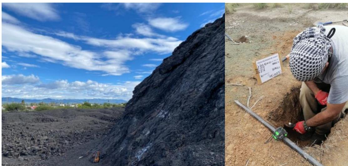
FIG. 33 MUESTREO EN LAS ESCORIAS DE MATEHUALA (IZQ.) Y EN SUELOS CONTAMINADOS POR LA EXFUNDICIÓN (DER.).
