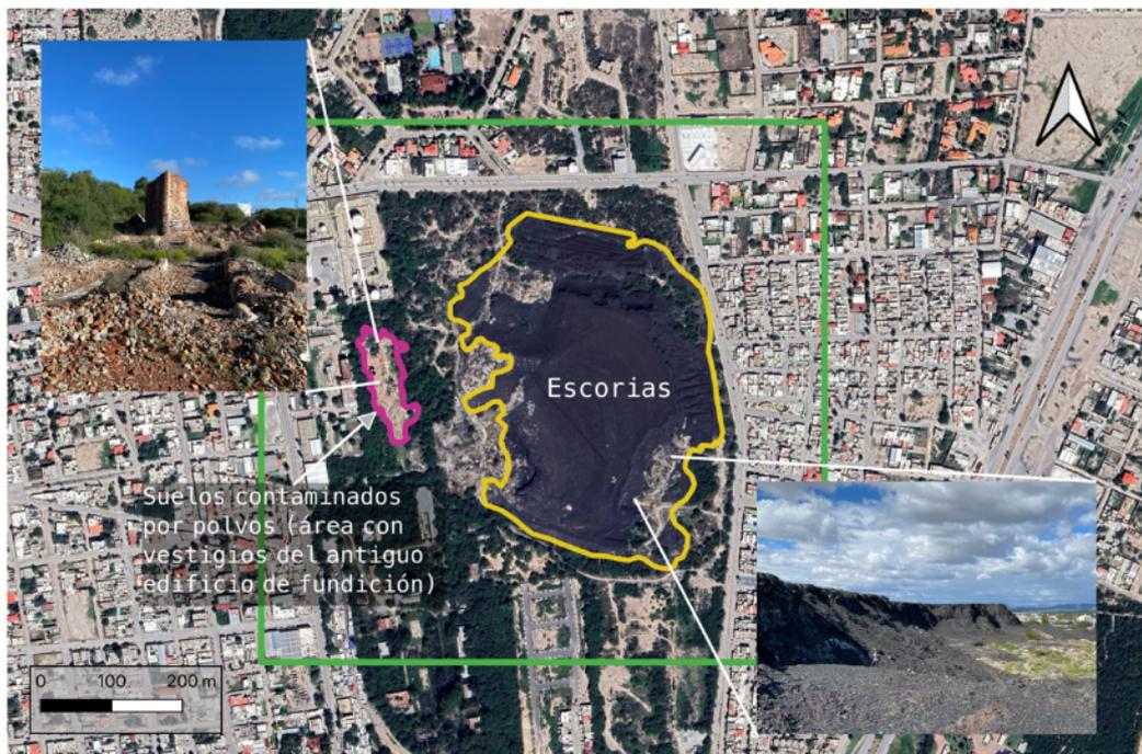
FIG. 23 UBICACIÓN DE RESTOS DE EX FUNDICIÓN Y SUELOS CONTAMINADOS POR POLVOS DE FUNDICIÓN (IZQ.) Y PILA DE ESCORIAS (DER.) EN MATEHUALA, SAN LUIS POTOSÍ.
