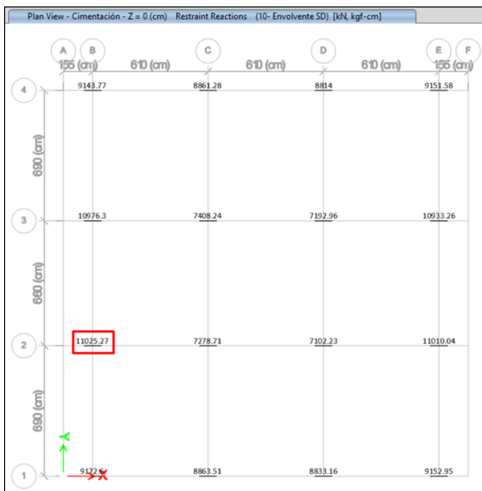
Imagen 41. Cargas máximas envolventes para diseño de aisladores deslizantes.
