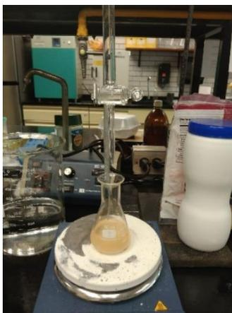
*Figura 49. Determinación de ácido cítrico*
