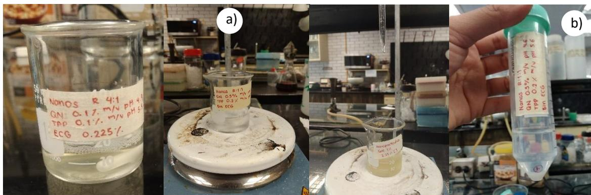
**Figura 42.** a) Síntesis de nanopartículas de quitosán por el método de gelificación iónica, b) Nanopartículas centrifugadas.
