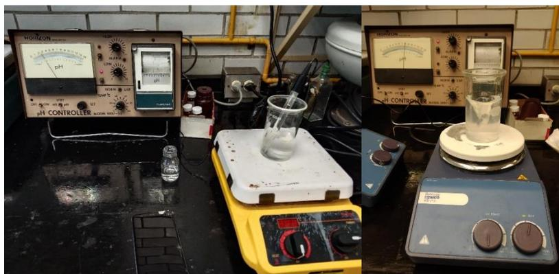
**Figura 37.** Determinación del grado de desacetilación del quitosán por titulación potenciométrica
