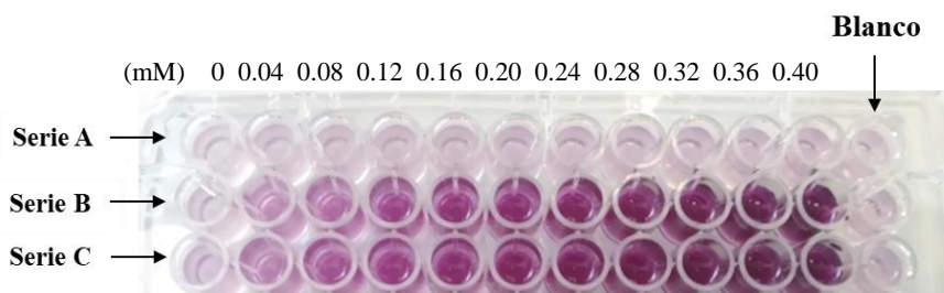
Figura 13. Formación de color para el ensayo Fe(III)-FZ en formato de MTPs.
