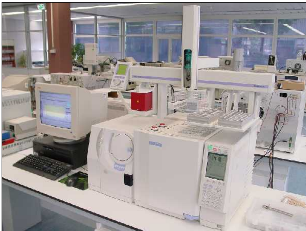
Figura 42. Sistema Shimadzu GC-MSD modelo GC2010, equipado con un auto muestreador AOC500 y un espectrómetro de masas GCMS QP2010
