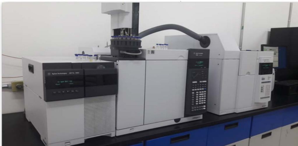
Figura 17. Fotografía de un Cromatógrafo de gases acoplado a un espectrómetro de masas modelo AGILENT 7890B/5977A
