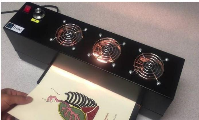
Imagen 34 y 35: Ejemplos de máquina de thermoform con dibujo en relieve.
