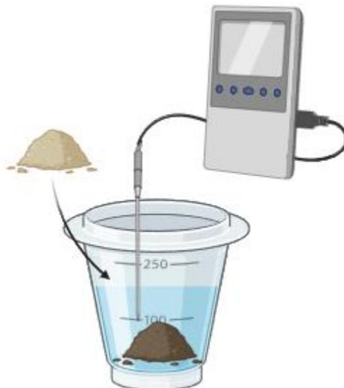
**Figura 8.** Arreglo experimental para la determinación del cambio de entropía en la interacción de sistemas acuosos y sólidos aislados
