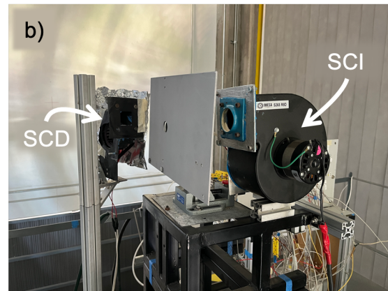
Figura 4.5: Receptor v.0.1. a) Estructura de soporte e instrumentación de la versión 0.1. del receptor. b) Receptor montado en la mesa de experimentos del horno enfriado por el SCD y SCI.
