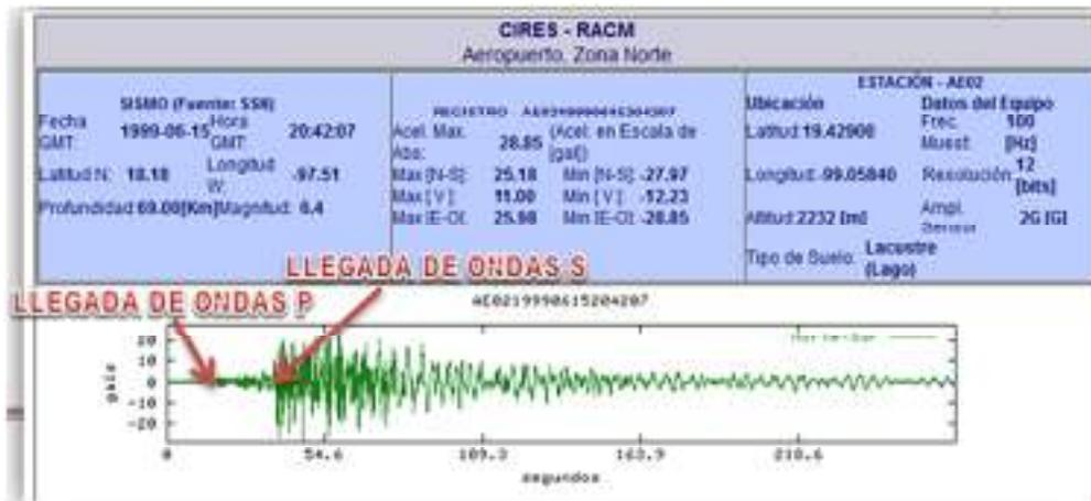
Figura 2.6 Acelerograma de un sismo obtenido de la RACM
