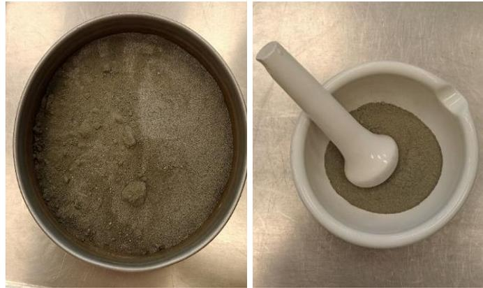
Figura 4.3 Homogenización del material en seco
