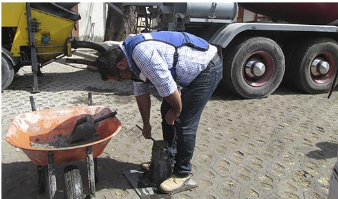
Imagen 59. Vaciado de la mezcla por tercios de acuerdo al volumen de la olla.
