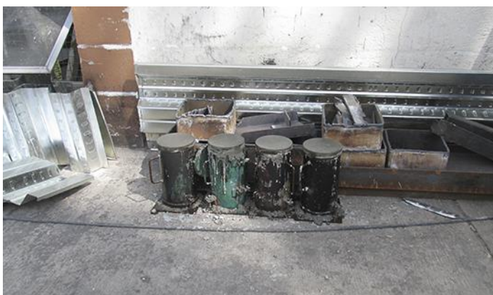
Imagen 61. Toma de muestras del concreto en estado fresco.
