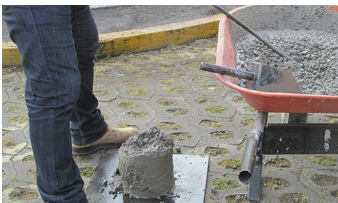
Imagen 60. Estado del concreto después del retiro del cono, observado como correcto.
