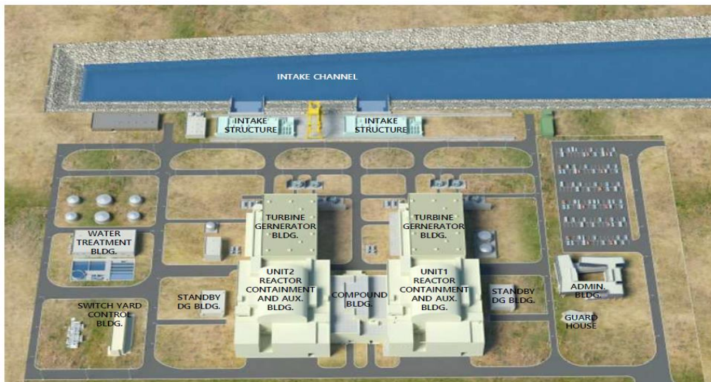
Figura 27. Layout de una central de generación SMART.
