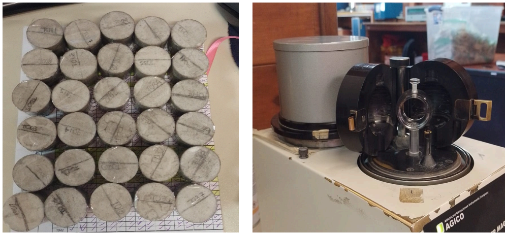
Figura 25. Muestras seleccionadas tratadas y calentadas para realizar el experimento de anisotropía
