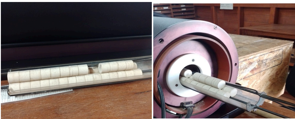
Figura 24. Paleointensidad. Pastillas de sal en el portamuestras, posteriormente se introducen al horno para realizar los experimentos de paleointensidad
