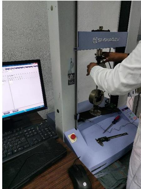
*Figura 2.5 Colocación del extensómetro de una probeta en la máquina universal SHIMADZU.*
