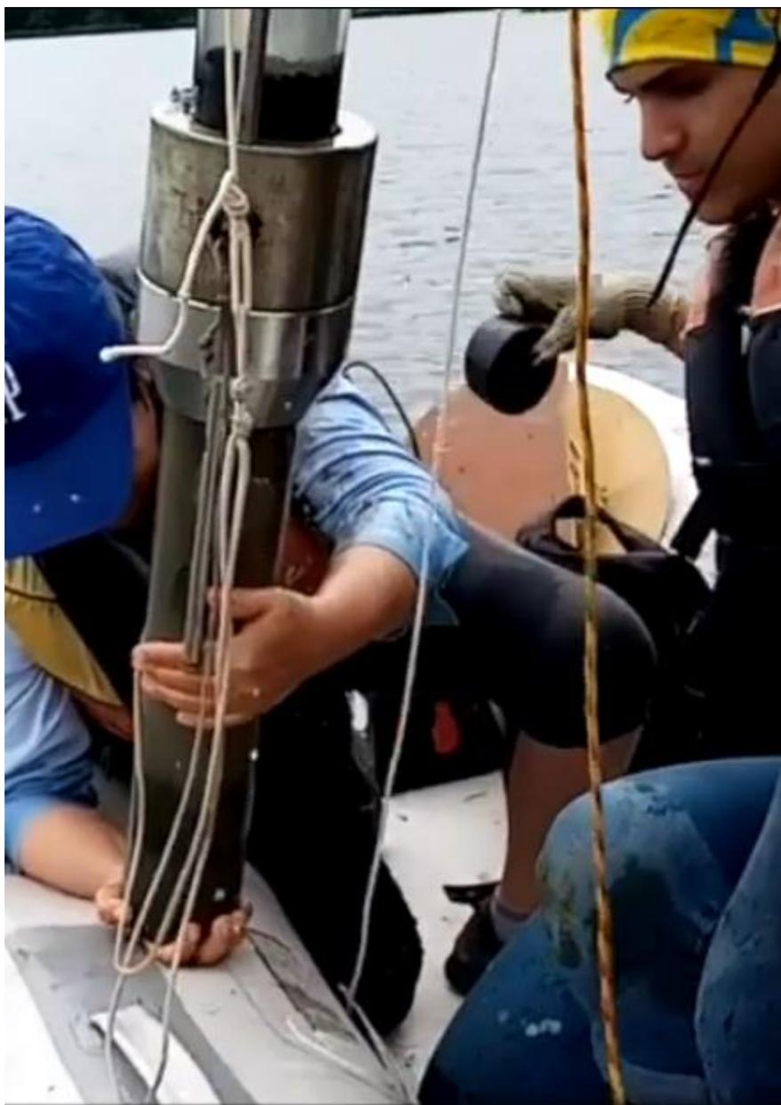
*Figura 18. Fotografía de núcleo de sedimento. En la parte superior del cilindro se observa el agua del fondo analizada en este estudio (Laboratorio de Paleolimnología, UNAM, 2020).*
