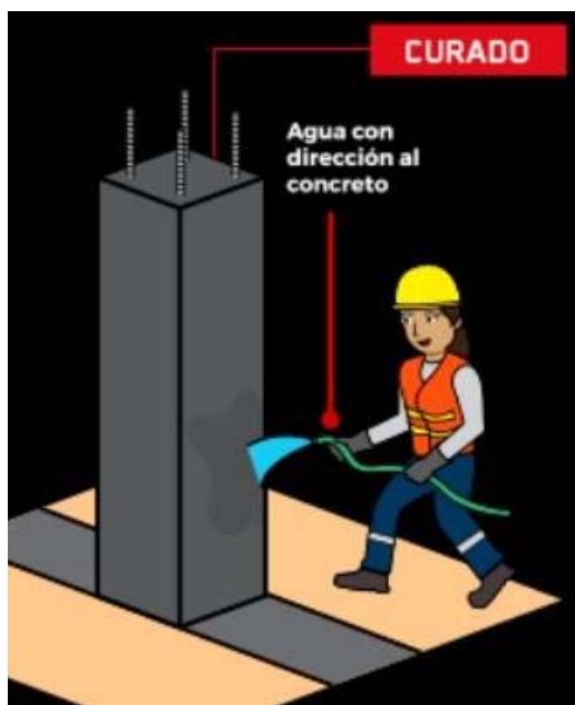
Figura 60. Ilustración del curado de concreto.
