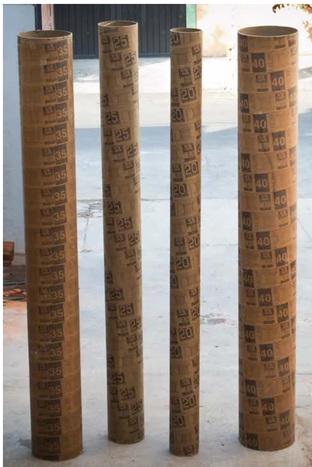
Figura 15. Sonotubos de distintos diámetros.
