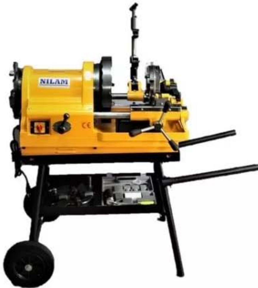
Figura 86. Roscadora eléctrica Nilam modelo NI-100D1.
