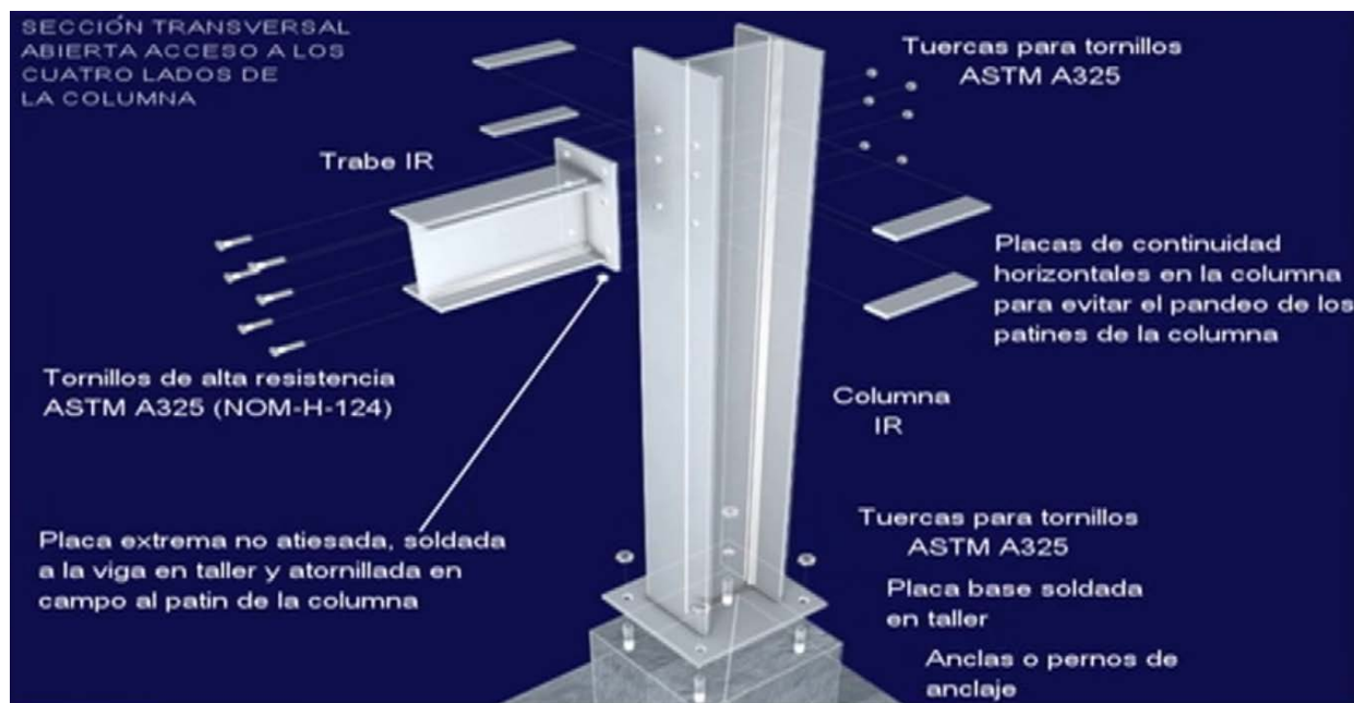
Figura 40. Diagrama y descripción de las partes de una conexión viga-columna rígida con placa de extremo.
