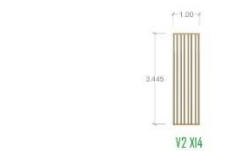
VENTANA CON CRISTAL DE 6 MM. CON BASTIDOR DE MADERA 15 X 4 CM. Y VIGUETAS DE MADERA 4X4
