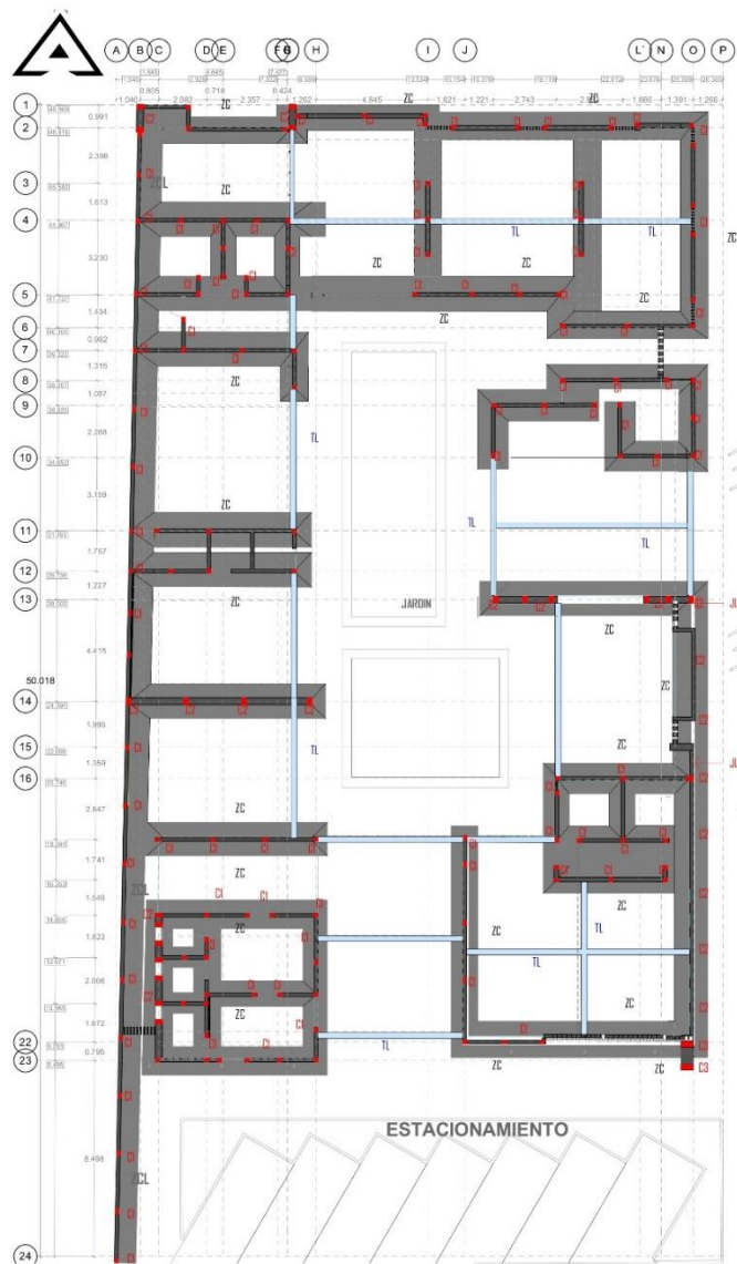
PLANTA DE CIMENTACIÓN ESC:1:100
