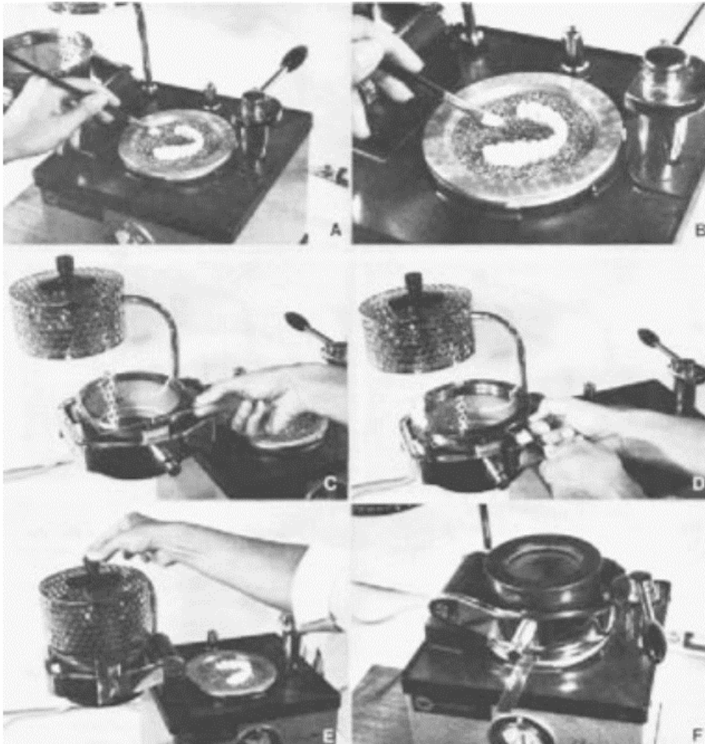
Figura 3. Fabricación de un retenedor invisible, usando una termoformadora Biostar. (A,B) Colocación del modelo dental en la cámara del modelo con bolitas de plomo cubriendo las zonas que no tocará el acrílico. (C) Colocación de la férula de 1 mm de grosor de Biocryl en la cámara de presión. (D) Colocación del marco de sujeción de seguridad sobre el Biocryl. (E) Colocación del elemento calefactor sobre la cámara de presión. (F) Colocación y fijación de la cámara de presión sobre el portamodelos, tomado de (2)
