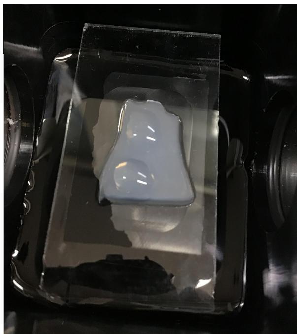
Figura 4.9: Porción de la membrana NDMX en la celda de medición del tensiómetro óptico.
