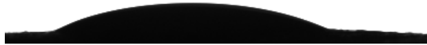
Figura 5.2: Perfil de gota sobre la superficie del hidrogel PEG-150/PVA, temperatura de medición 37°C
