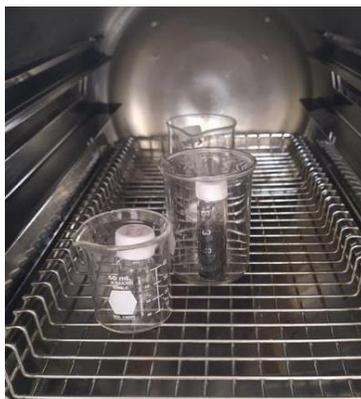
**Figura 13.** Esterilización de nanopartículas de sulfuro de plata (solución) mediante el uso de autoclave (fuente propia).
