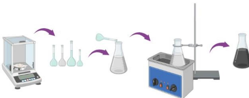
**Figura 7.** Protocolo de síntesis del sulfuro de plata asistida por ultrasonido (fuente propia).
