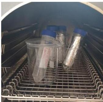
**Figura 15.** Esterilización de nanopartículas de sulfuro de plata (polvo-líquido) mediante el uso de autoclave (fuente propia).
