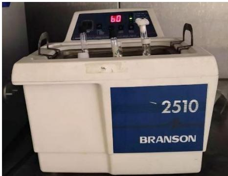
**Figura 17.** Vibración ultrasónica de muestras estériles (fuente propia).
