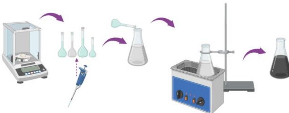
**Figura 8.** Protocolo de síntesis del sulfuro de plata con adición PEG asistida por ultrasonido (fuente propia).
