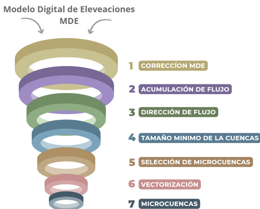
Figura 6. Esquema del proceso automático para la delimitación de microcuencas con la herramienta “hidrología” disponibles en el programa Qgis 3.10
