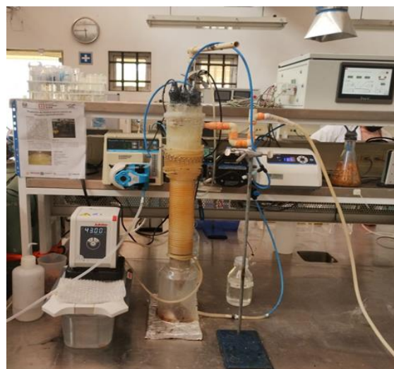
Figura. 4.2 Esquema ilustrativo e imagen del reactor UASB para la producción de \text{H}_2 a partir de lactosuero ácido.
