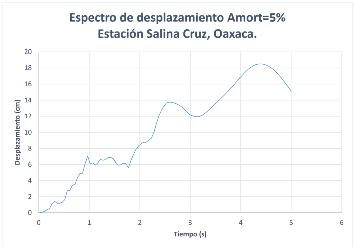
Figura A6 Espectro de desplazamiento, Salina Cruz.
