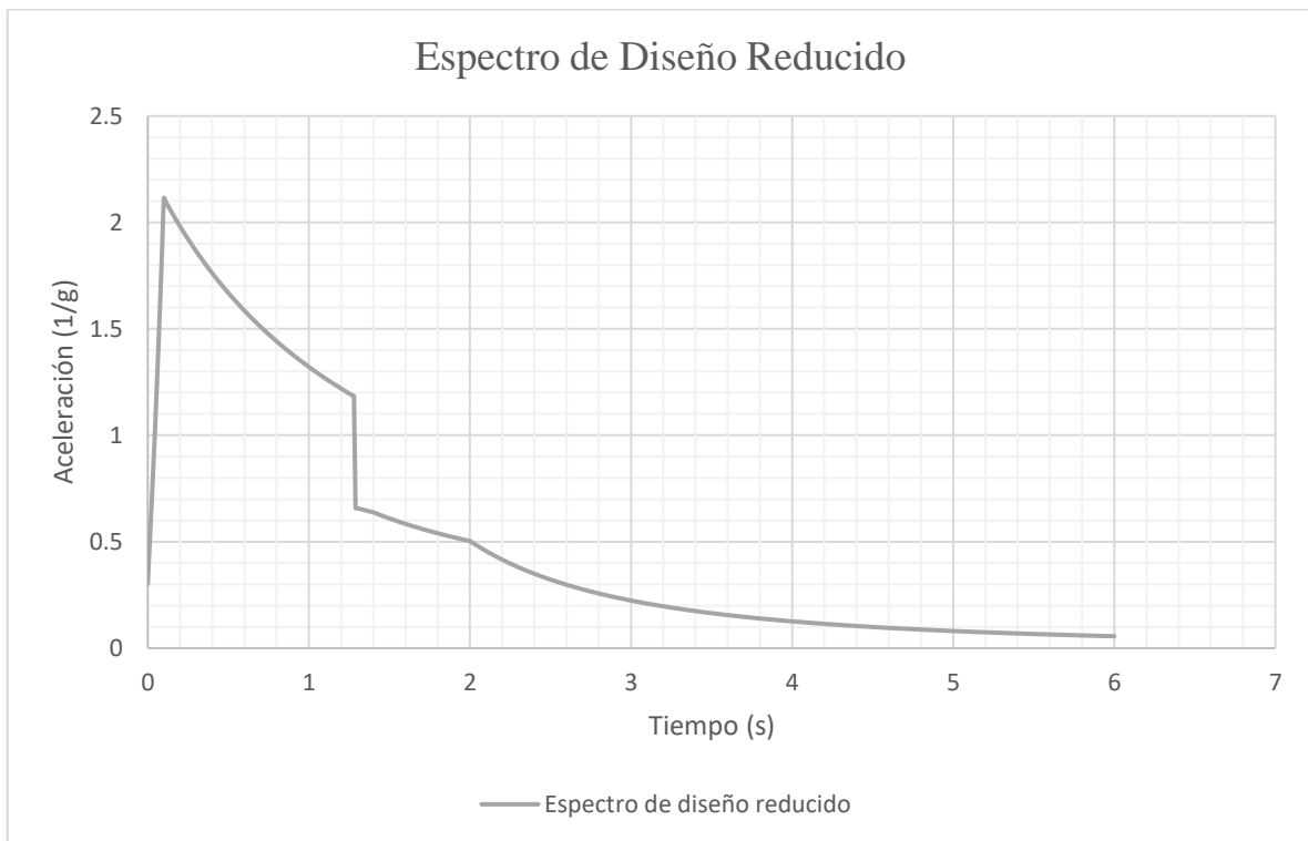
Figura A15 Espectro de diseño reducido
