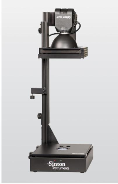
Figura 1.20: WTC-120PL - Medida del tiempo de vida en obleas con un detector Sinton<sup>[56]</sup>.
