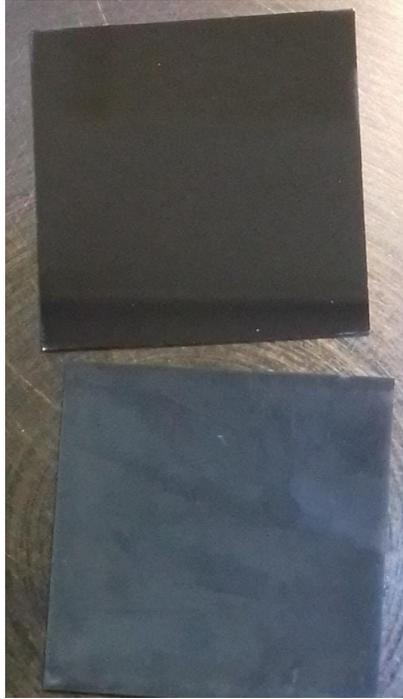
Figura 2.4: Sustrato pulido (arriba) vs sustrato texturizado (abajo).
