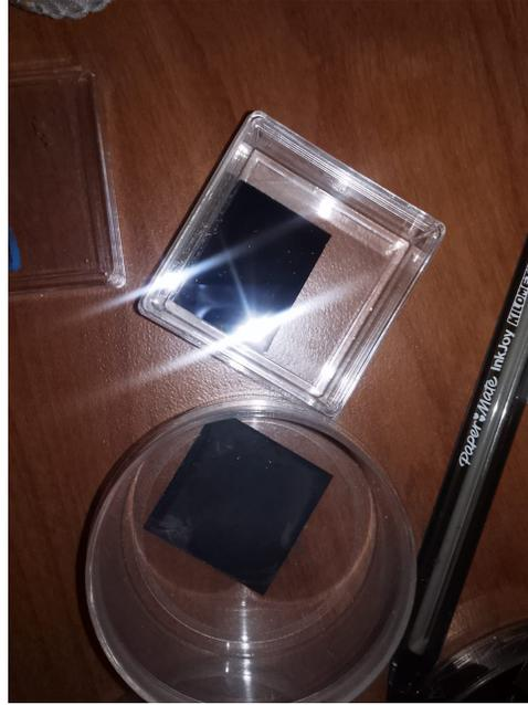
Figura 2.5: Silicio pulido (arriba) vs silicio con tratamiento MACE (abajo).
