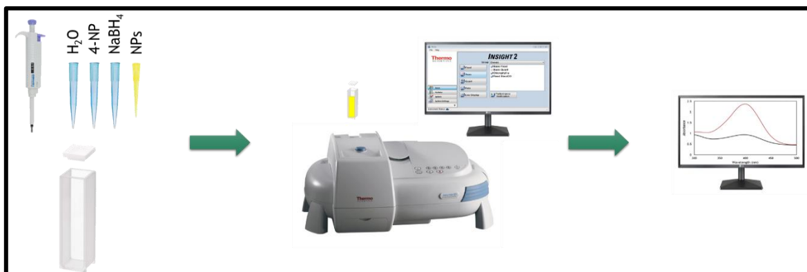
Figura 26. Procedimiento experimental para la medición por espectroscopía UV-Vis en la reacción de reducción de 4-NP.
