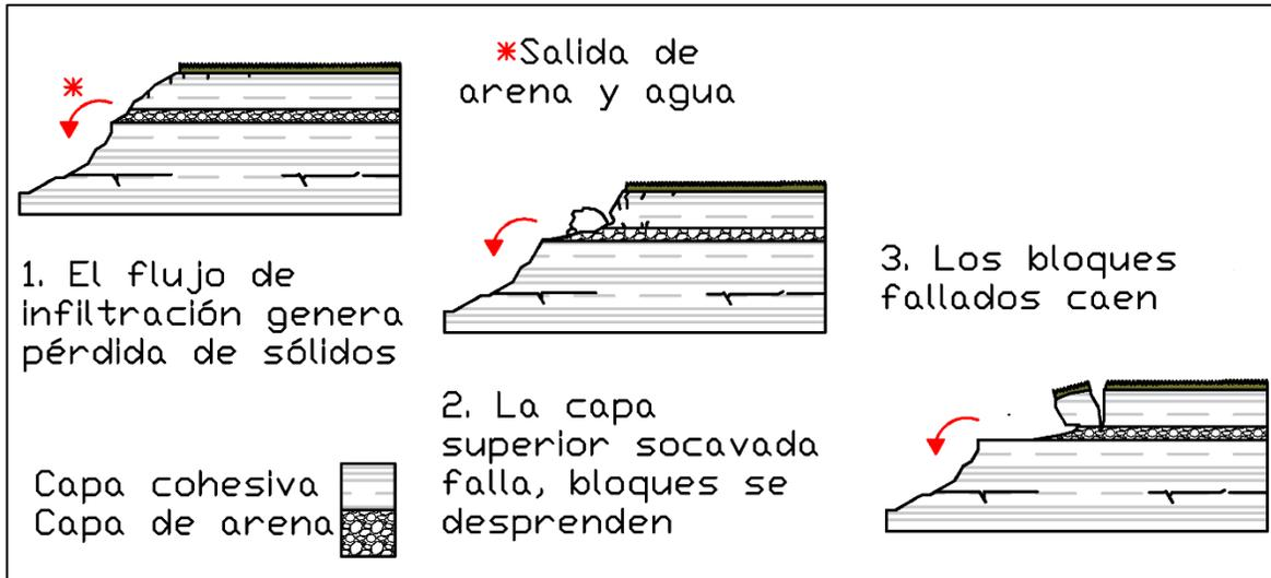
Figura 11 Proceso de falla por tubificación. Imagen modificada de (Nardi, 2011).
