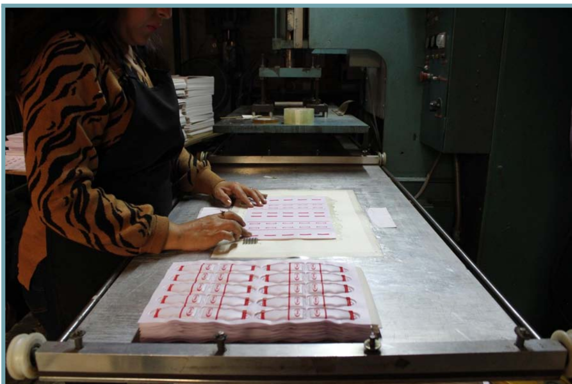
Una empleada de Abastecedora de Artículos de Vinil Azteca (ABAZTEK), la cual es una pequeña empresa mexicana dedicada al sector secundario, acomoda material encima de una de las dos charolas de una máquina de sellado de alta frecuencia con el fin de elaborar 20 llaveros de Yakult. (Fotografía: Diego Flores Téllez).
