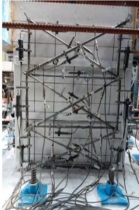
Figura 2.20: Transductores de desplazamiento tras ser colocados en un espécimen.
