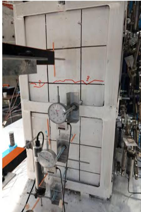
Figura 3.21: Grietas por flexión en la cara Oeste, durante el semiciclo -3 (0.05 % de distorsión).
