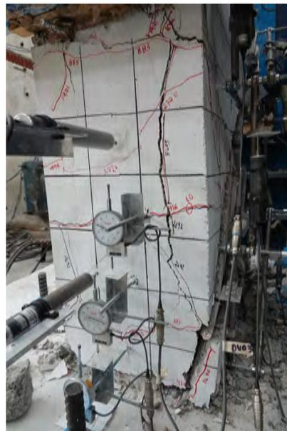
(d) Estado final del espécimen  $O^*$ , cara Oeste.Figura 3.6: Estado final del espécimen  $O^*$ .
