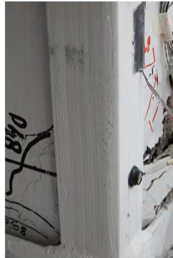
(a) Desprendimiento de cal en la solera inferior. (b) Desprendimiento de cal en el ala del ángulo.
