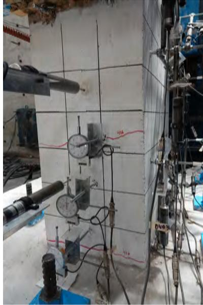
Figura 3.1: Grietas por flexión en la cara Oeste, en el semiciclo 4 (0.06 % de distorsión).
