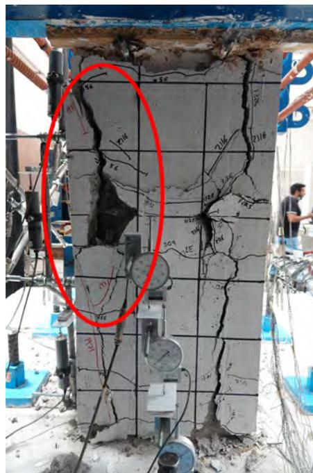
Figura 3.5: Acero de refuerzo interno visible en el semiciclo -12 (2% de distorsión).
