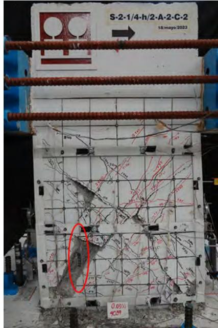
Figura 3.28: Refuerzo interno de acero, visible a través del agrietamiento, en el semiciclo -17 (3% de distorsión).
