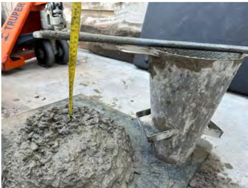
(a) Prueba de revenimiento en el concreto.
