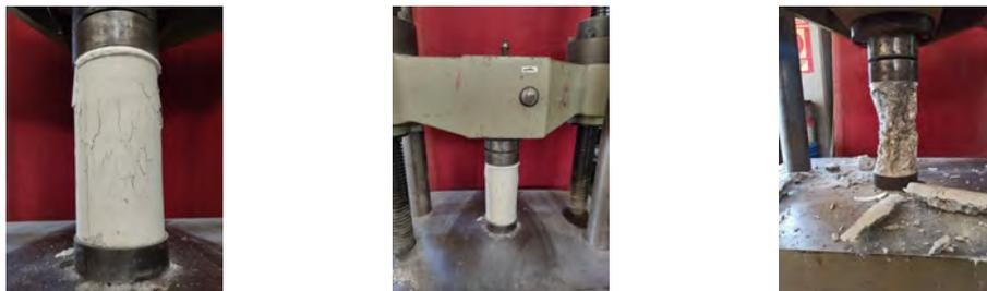
Figura A.1: Ensayo en cilindro de concreto, mediante el sistema de carga *MTS*.
