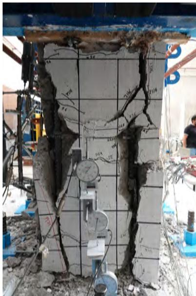
(c) Estado final del espécimen  $O^*$ , cara Este.
