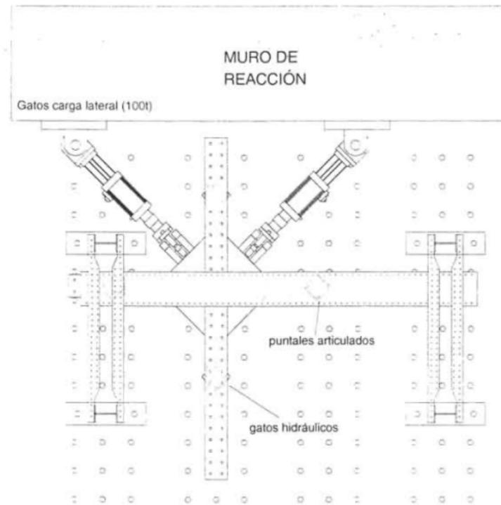
Figura 1.22: Esquema del marco de carga utilizado en los ensayos (Ascencio, 2005).
