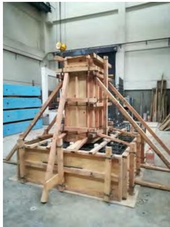
Figura 2.13: Cimbra de los especímenes (Alcocer et al., 2023).
