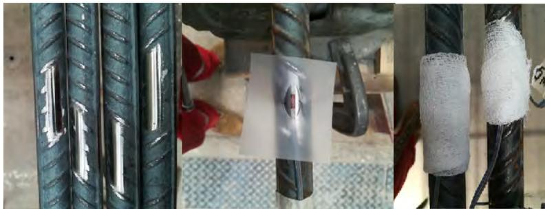
Figura 2.17: Etapas de la colocación de los deformímetros eléctricos (Alcocer et al., 2023).
