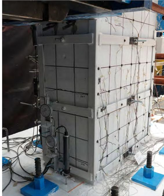
Figura 3.8: Grietas por flexión en la cara Este, durante el semiciclo 4 (0.06 % de distorsión).
