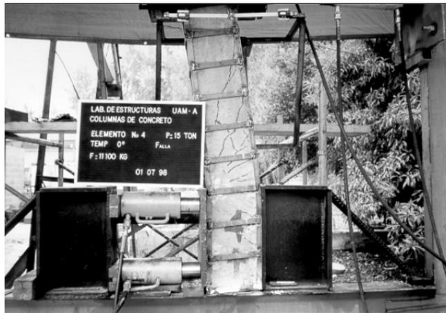
Figura 1.20: Vista de un espécimen durante una prueba (Cuevas et al., 2007).
