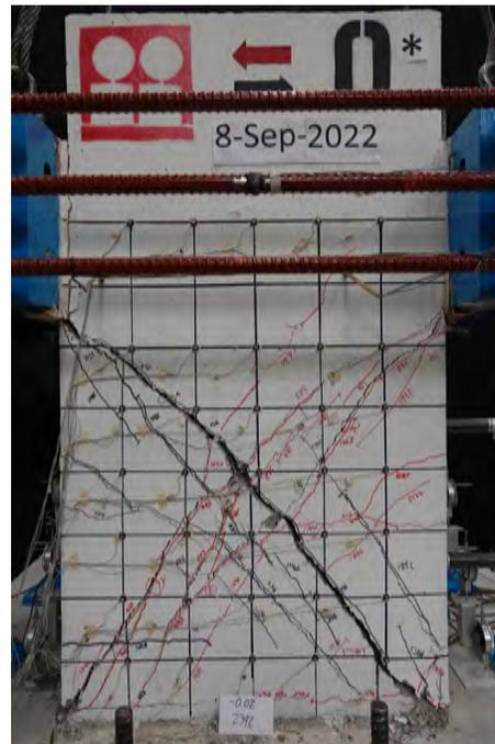
Figura 3.4: Estado del espécimen en el semiciclo -12 (2% de distorsión), cara Norte.
