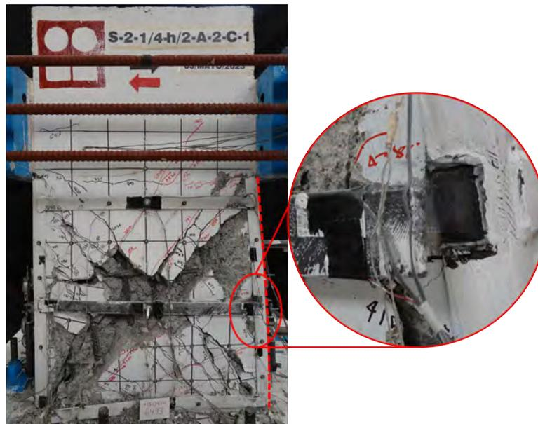
Figura 3.18: Falla de la soldadura de la solera intermedia, durante el semiciclo -21 (4% de distorsión).
