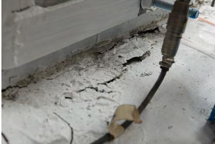
Figura 3.12: Desprendimiento de concreto en la conexión zapata-columna.
