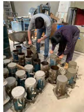
(b) Elaboración de cilindros para los ensayos.
