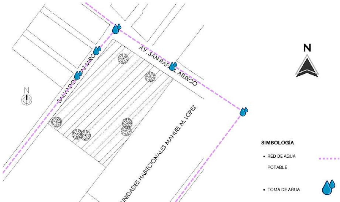
Imagen 53. Red de agua potable en el terreno de estudio
