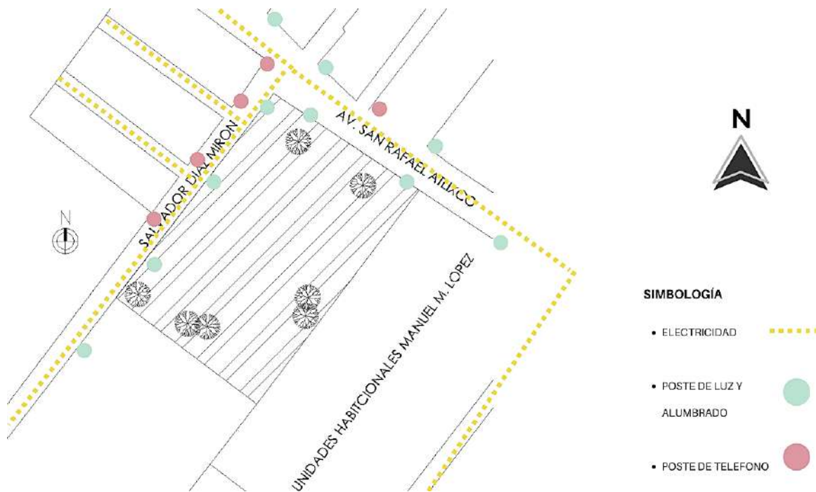
Imagen 54. Red eléctrica y de alumbrado público en el terreno
