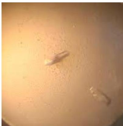
**Figura 37. Cristales de la CaUMPS.** Cristales obtenidos en la condición de cristalización PEG 10,000 al 20% (w/v) y 100 mM de HEPES a pH 7.5, en presencia de los sustratos del dominio CaOPRTasa PRPP 5 mM, AO 25 mM y MgCl<sub>2</sub> 5mM utilizando una concentración final de proteína de 9 mg/mL.
