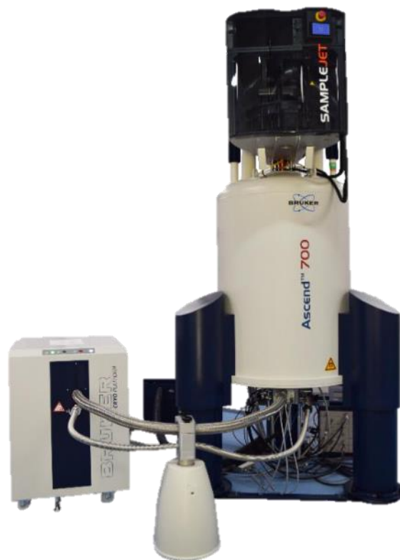
Figura 4: Espectrómetro Bruker Avance III de 16.44 Tesla (700 MHz para ^1\text{H} ).
