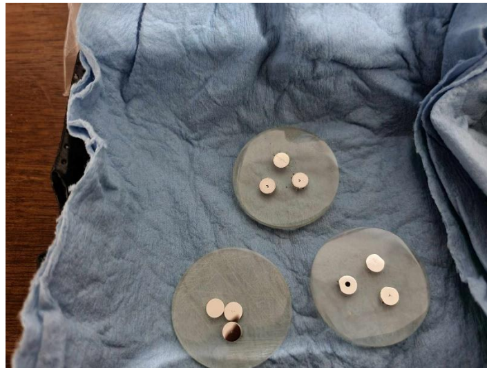
Figura 16: Aleaciones montadas en resina epóxica.
