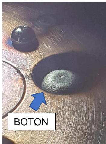
Figura 15. Botón solidificado sobre solera de cobre dentro de la cámara del horno de arco eléctrico.
