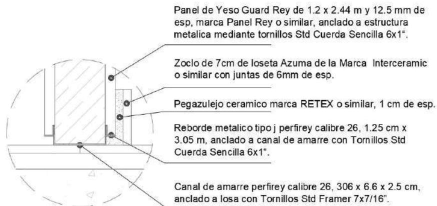
**Figura 105** | Croquis de detalle de estructura metálica / Realización propia. / 2023
