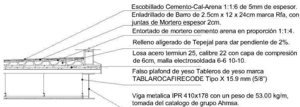
**Figura 93** | Croquis de azotea horizontal losacero / Realización propia. / 2023
