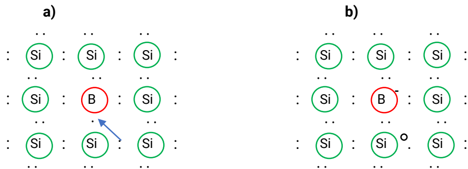
Figura 1.10. Esquema de una red de silicio dopada con boro, donde a) el fósforo tiene 3 electrones de valencia por lo que no puede formar los 4 enlaces de la red de silicio y un electrón de un átomo vecino cubre esa deficiencia y b) el boro queda con carga -1 por aceptar el electrón y se forma un hueco por el electrón que se movió.
