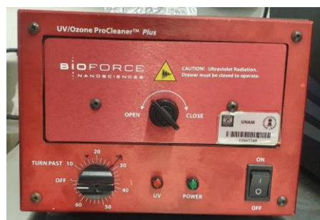
Figura 2.5. Cámara de irradiación de UV/Ozono.
