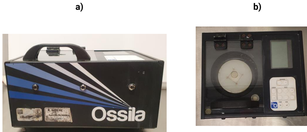
Figura 2.9. Equipo de depósito de películas delgadas por rotación: a) vista frontal y b)
