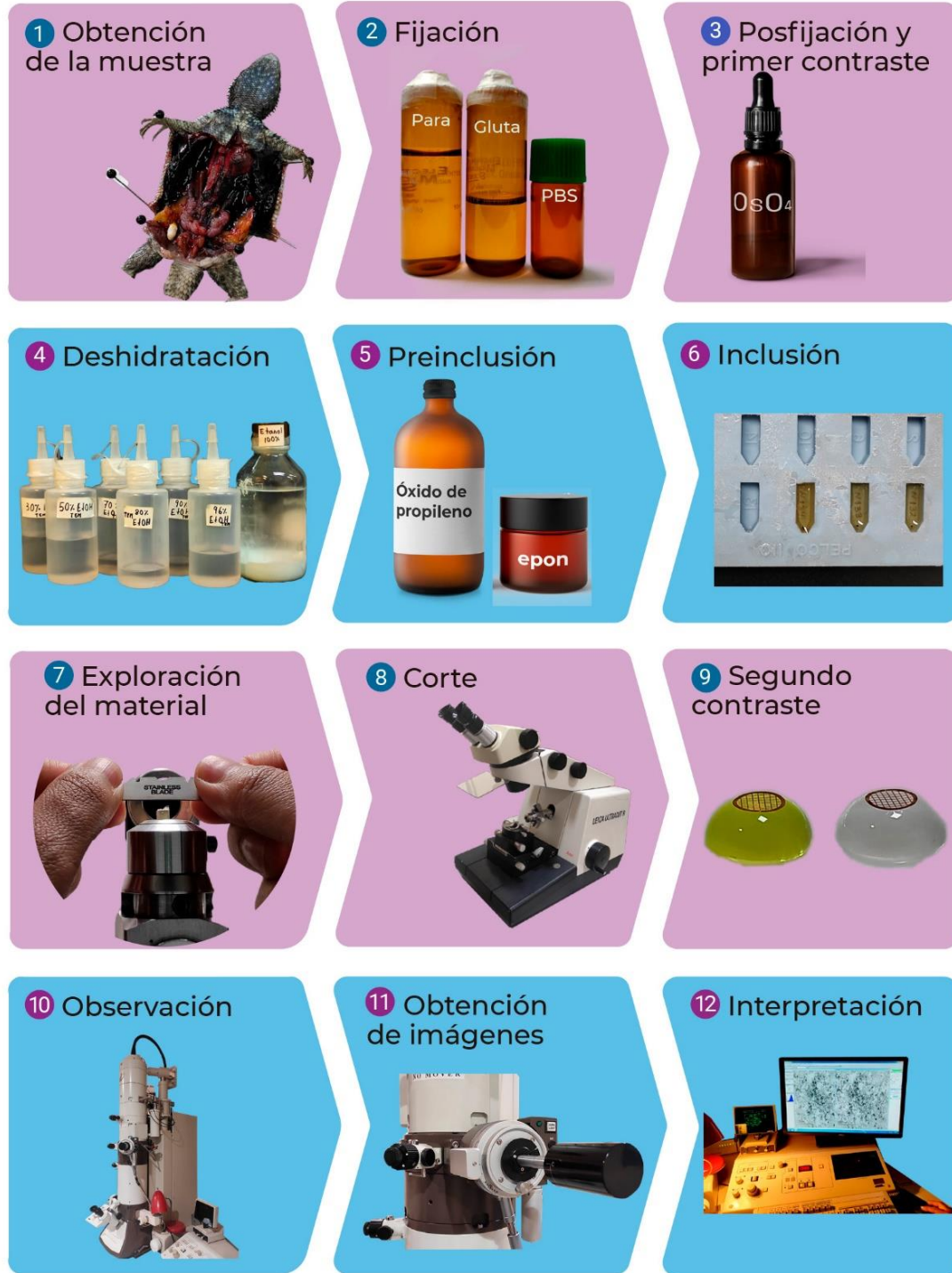
Fig. 7. Representación del procesamiento convencional de la muestra biológica desde la obtención de la muestra hasta la interpretación de las micrografías. Fijación con mezcla de aldehídos, inclusión en resina epóxica, primer contraste con tetraóxido de osmio y segundo contraste con acetato de uranilo y con citrato de plomo.
