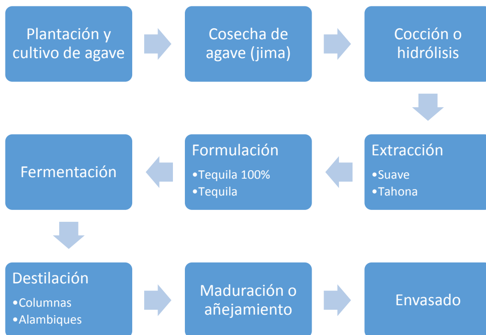
Figura 4. Diagrama de proceso de elaboración de Tequila (Elaboración propia).
