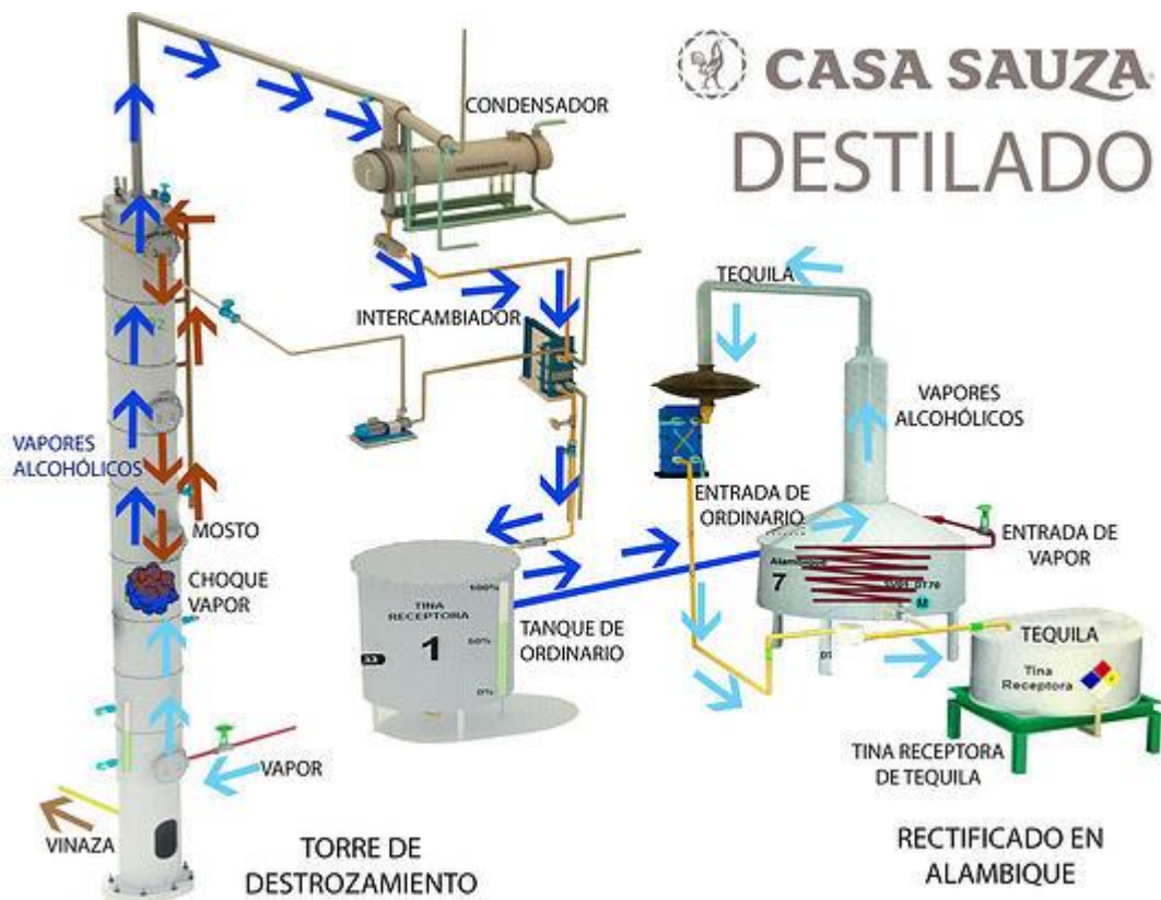
Figura 2. Proceso de destilación de Tequila, mediante la utilización de columna de destilación y alambiques (Cornejo Trujillo, 2017).
