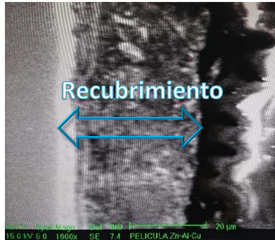
Figura 33. Micrografía de una placa con 15 capas de zinalco.
