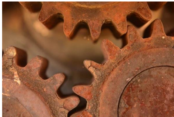
Figura 11. Herrumbre presente en engranes de acero debido a la corrosión atmosférica. [33]
