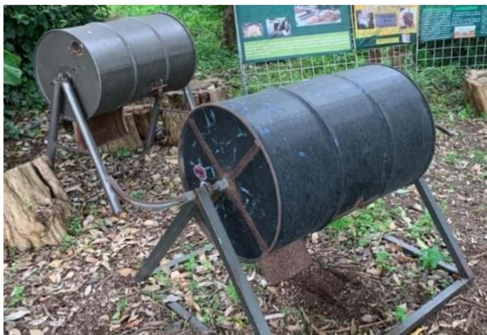
**Figura 16.** Tambos rotatorios auto fabricados y reciclados de acero con capacidad de 200 litros y rotación sobre cumaceras. Fotografía tomada en el Jardín etnobotánico de la UNAM (Ciudad Universitaria)
