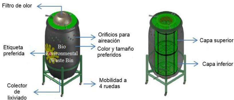
**Figura 15.** Compostero de tambo vertical, con filtro, y movilidad. Modificado, traducido y tomado de Lunag et al. (2021)
