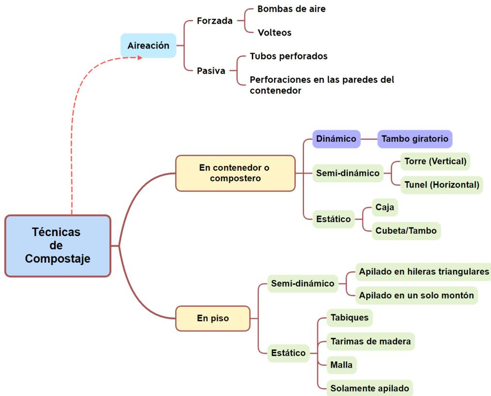
**Figura 4.** Esquema de técnicas de compostaje. Adaptación de la información de Gruneklee (1998) y Zurbrügg (2014)
