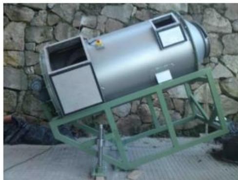
**Figura 25.** Tambo rotatorio automatizado de 1'500 litros con rotación a través de un espiral sin fin y con un sistema de descarga por medio de un pistón. Tomado de Vázquez et al. (2020)
