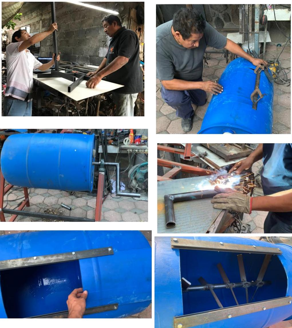
**Figura 29.** Fotografías de construcción colaborativa en el taller de herrería
