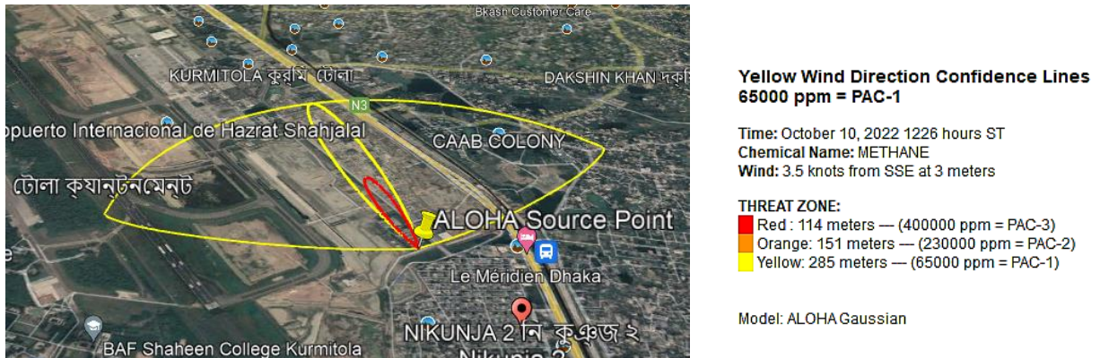
Figura 3. Área tóxica de nube de vapor de metano (ALOHA).
