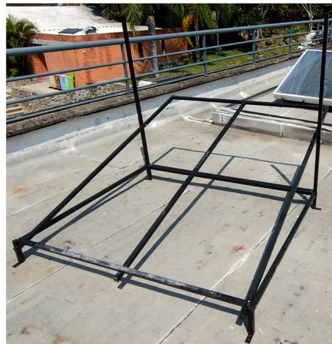
Figura 4.18: Base metálica ajustable.
