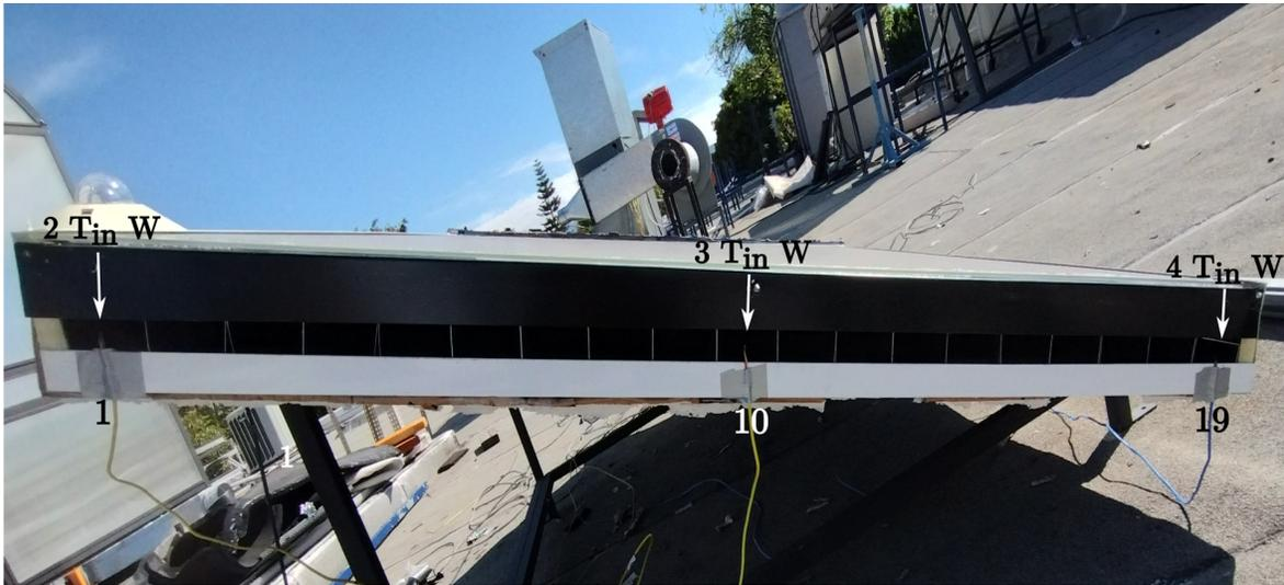
Figura 3.11: Identificación de los sensores colocados a la entrada del captador sin el sistema de precalentamiento.
