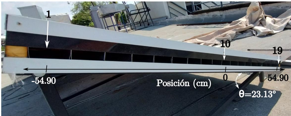
Figura 6.1: Identificación de los sensores en el nuevo sistema de referencia a la entrada del captador
