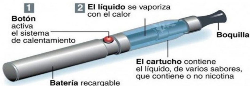
Figura 1. Componentes básicos de un vaporizador o cigarrillo electrónico (22).
