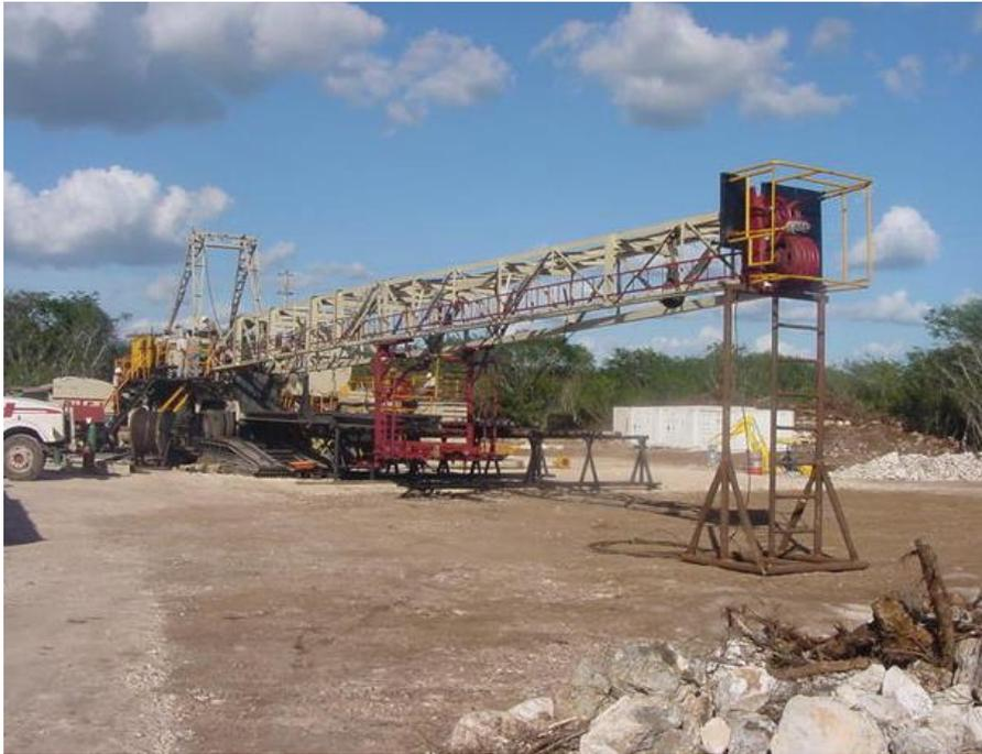
**Fig. 31** Se muestra la torre de perforación antes de ser levantada a la posición de perforación.
