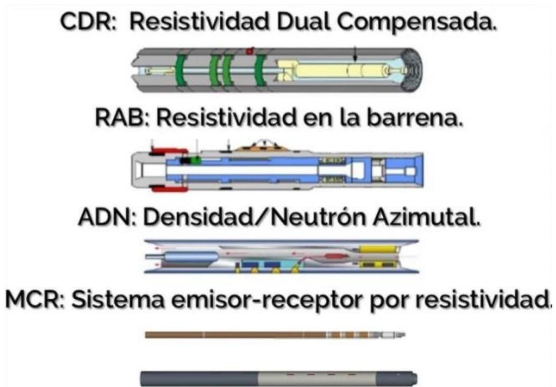
Fig. 13 Se muestra un equipo para la toma de registros eléctricos LWD (Perfoblogger, 2020)
