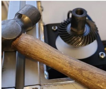
*Figura 7.6 Montaje de corona en el motor.*
