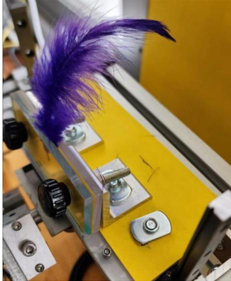
*Figura 8.19 Desprendimiento de material en la pluma.*
