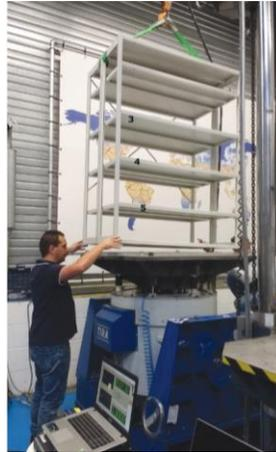
Figura 2.7 Agitador electrodinámico marca TIRA GmbH usado en [5].
