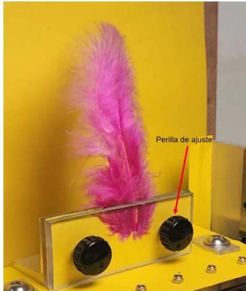
Figura 7.12 Pluma sujeta entre la mordaza de la máquina agitadora.
