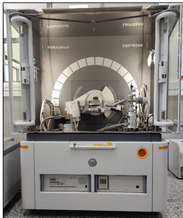
Figura 4.6. Difractómetro PANalytical EMPYREAN usado para la determinación semicuantitativa de la composición mineral del núcleo IR-1.
