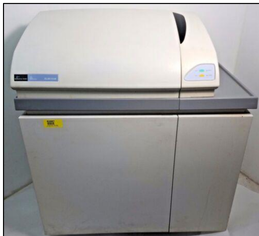
Figura 4.9. Espectrometro de masas Perkin Elmer Sciex ELAN 6100 utilizado para determinar la composición química de las muestras del núcleo IR-1
