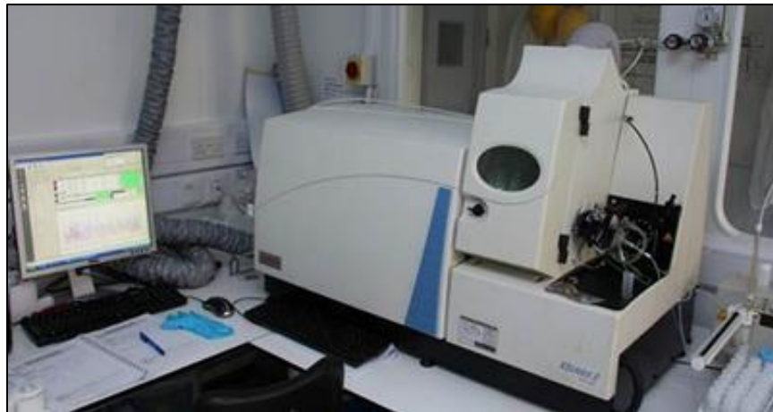
Figura 4.11. Espectrómetro de masas con plasma acoplado inductivamente Thermo X Series II usado para la datación de bentonitas por U-Pb.
