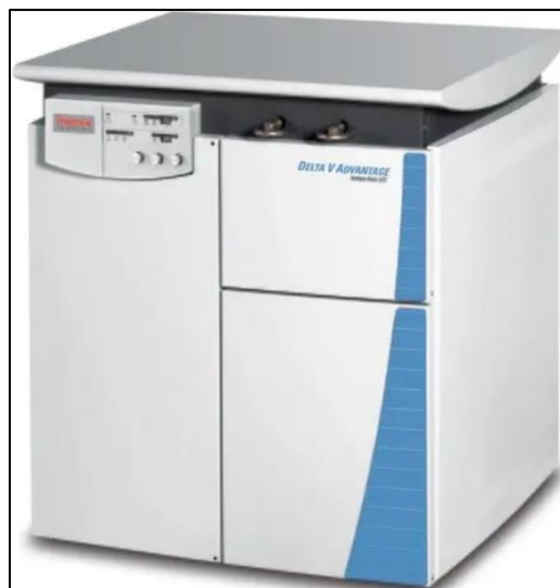
Figura 4.10. Espectrómetro de masas de relaciones isotópicas Thermo Finnigan Delta V Advantage utilizado para conocer la relación isotópica de C en materia orgánica de las muestras del núcleo IR-1.
