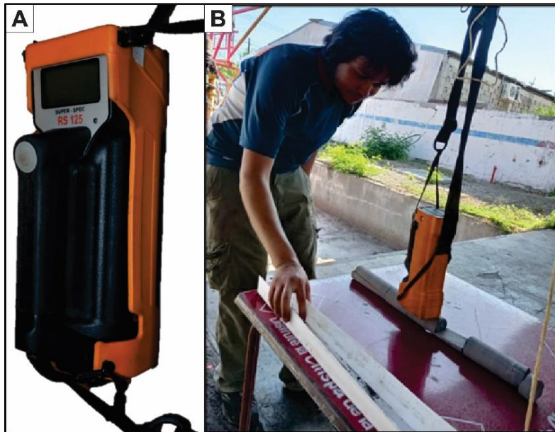
Figura 4.4. Obtención de la señal de rayos gamma estándar. (A) Escintilómetro RS 125 SUPER SPEC utilizado para el análisis de rayos gamma de los núcleos IR-1 e IR-2. (B) Proceso de medición de rayos gamma implementado en los núcleos IR-1 e IR-2.
