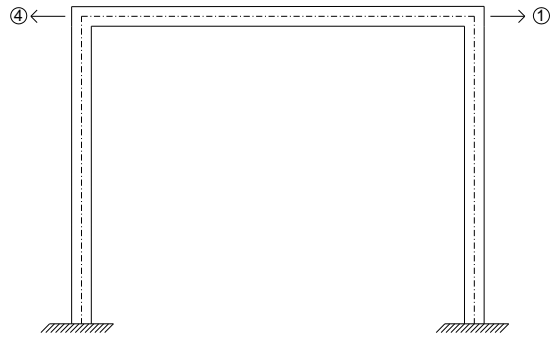
Fig. 03. Estructura sin desplazamientos verticales.
