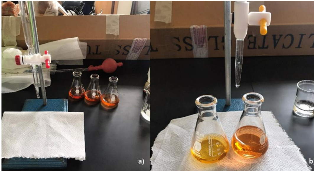
Figura 4.16 Determinación de alcalinidad. a) montaje del equipo de titulación; b) vire del color amarillo a naranja canela producido por el indicador anaranjado de metilo.
