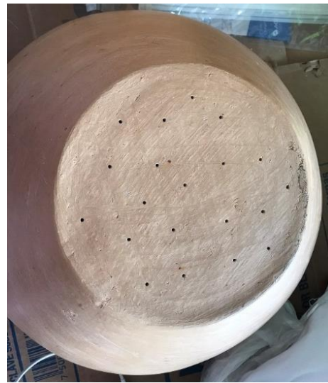
Figura 4.9 Difusor para distribuir la salida del agua sobre la marmolina
