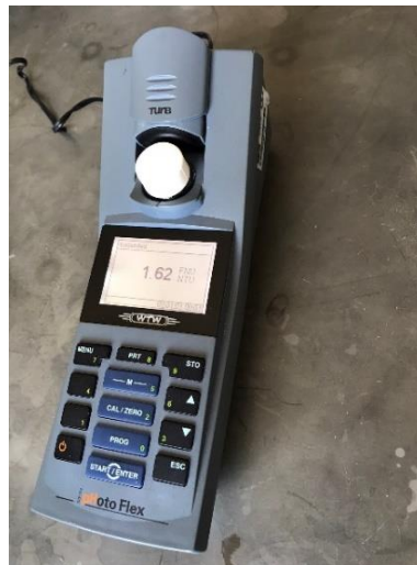
Figura 4.14 Evaluación de turbidez mediante turbidímetro portátil marca WTW modelo pHotoFlex® Turb
