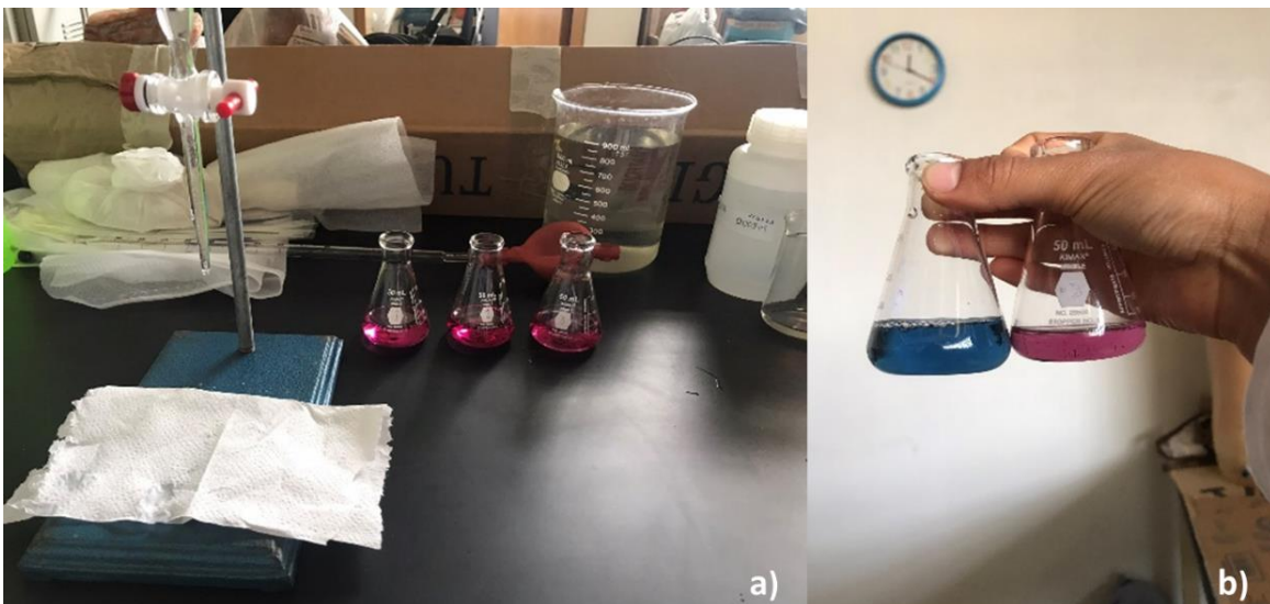
Figura 4.15 Determinación de dureza total. a) montaje del equipo de titulación; b) vire del color rosa a azul producido por el indicador Eriocromo negro T.
