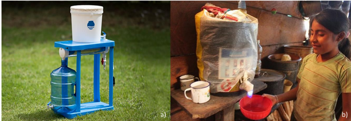
Figura 3.1 Tecnologías para la purificación del agua a) Mesita azul diseñada por Cántaro Azul. Obtenida de: https://www.cantaroazul.org/tecnologias b) LlavEOZ en una comunidad rural implementada por Grupo EOZ. Obtenida de: https://ecotec.unam.mx/ecoteca/
