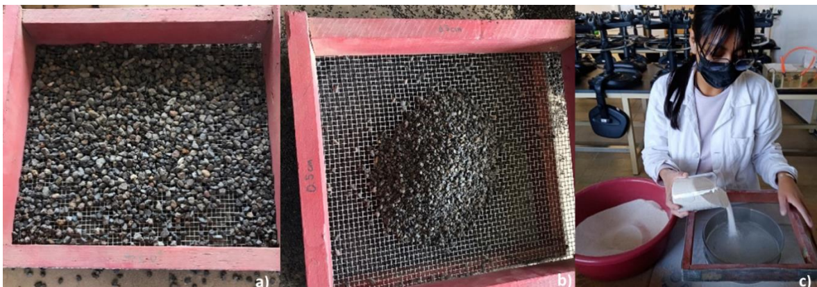
Figura 4.5 Tamizado de la grava y marmolina. a) separación de grava gruesa entre 1.0 a 0.5 cm; b) separación de grava fina entre 0.5 a 0.1 cm; c) separación de marmolina entre 0.25 mm
