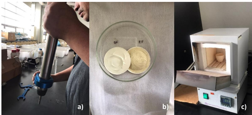
Figura 4.18 Determinación de sólidos totales. a) Montaje de equipo de filtración Millipore. b) membranas Millipore con sólidos suspendidos. c) crisol en la mufla.
