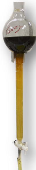
Figura 24 Cromatografía en columna (sílica gel 60) del extracto hidroalcohólico de D. bicolor L. usando como fase móvil cloroformo-ácido acético 50:50.
